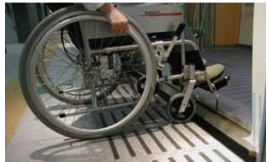
ホームと車両の段差解消
