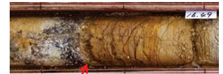
博多粘土上部層/Dc2層上端境界
