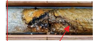
博多粘土上部層/Dc2層上端境界
