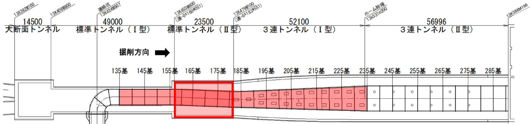
【先進導坑掘削完了時点】
