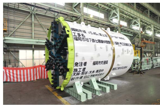
▲ 発進前のシールドマシン
