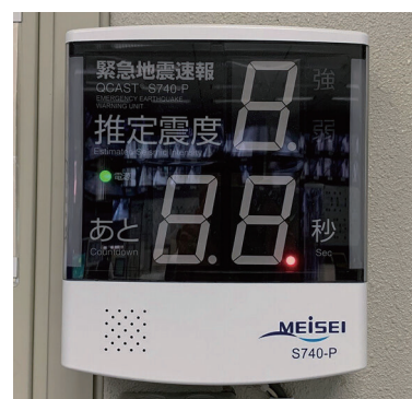
緊急地震速報受信装置
