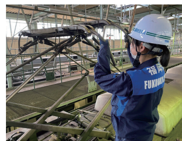
パンタグラフ点検
