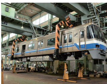
車両基地での点検風景
