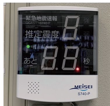
緊急地震速報受信装置
