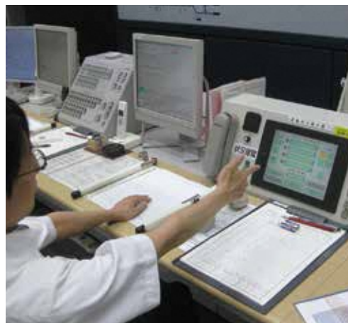
七隈線用列車無線
