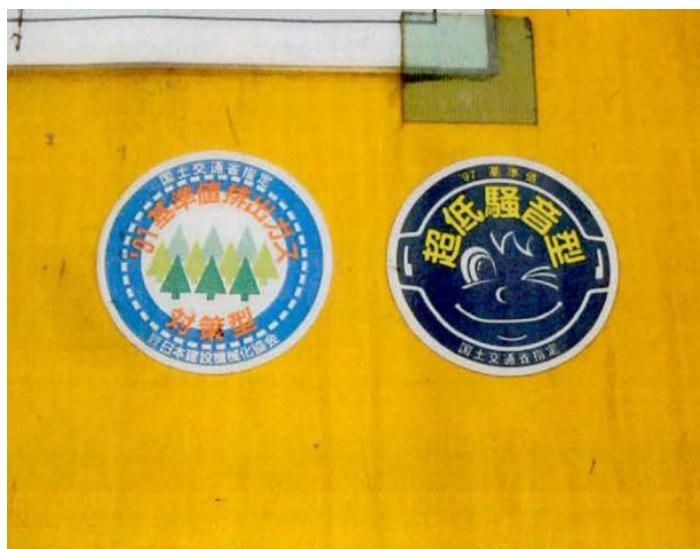
写真 9-1-2 環境保全措置の実施状況（低騒音型建設機械の採用）
