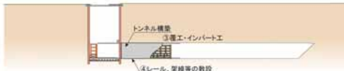
図 1.4-8 施工順序図 (NATM)
