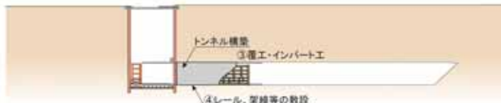
図 1.4-8 施工順序図 (NATM)
