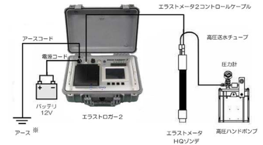
図3) - 1 孔内水平載荷試験装置の概要
