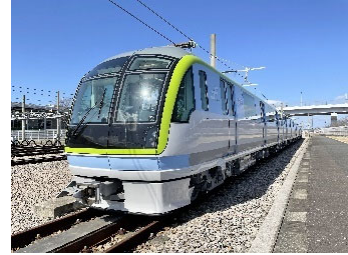
七隈線車両（アルミ製）
