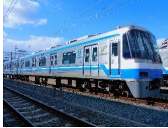
空港・箱崎線車両（ステンレス製）
