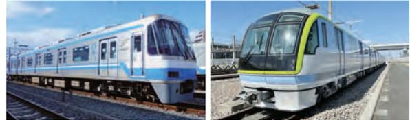
空港・箱崎線車両（ステンレス製） 七隈線車両（アルミ製）
