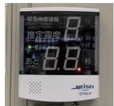
緊急地震速報受信装置
