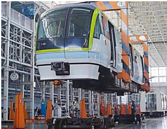
車体と台車の分離作業
