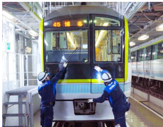
車両前面の点検
