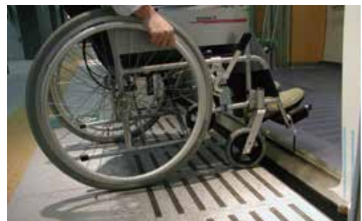
ホームと車両の段差解消
