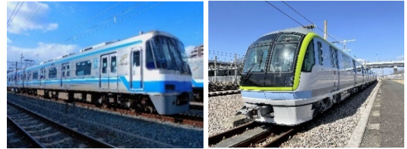
空港・箱崎線車両（ステンレス製） 七隈線車両（アルミ製）
