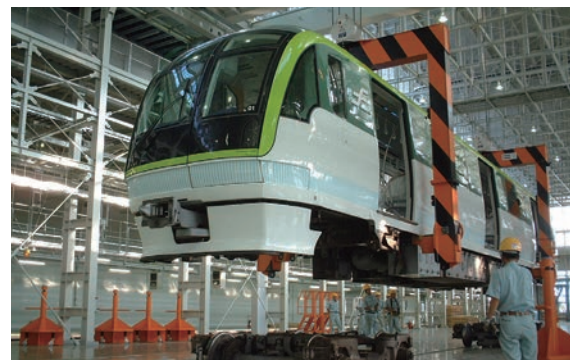
重要部・全般検査
