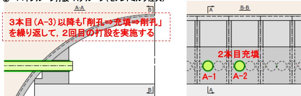
④パイプルーフ打設 Bグループ(鋼管打設)
