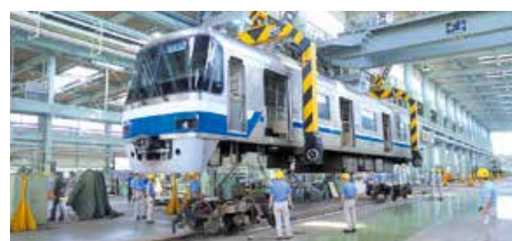
重要部・全般検査
