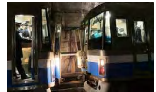
救援列車による故障車両の併結・回送訓練
